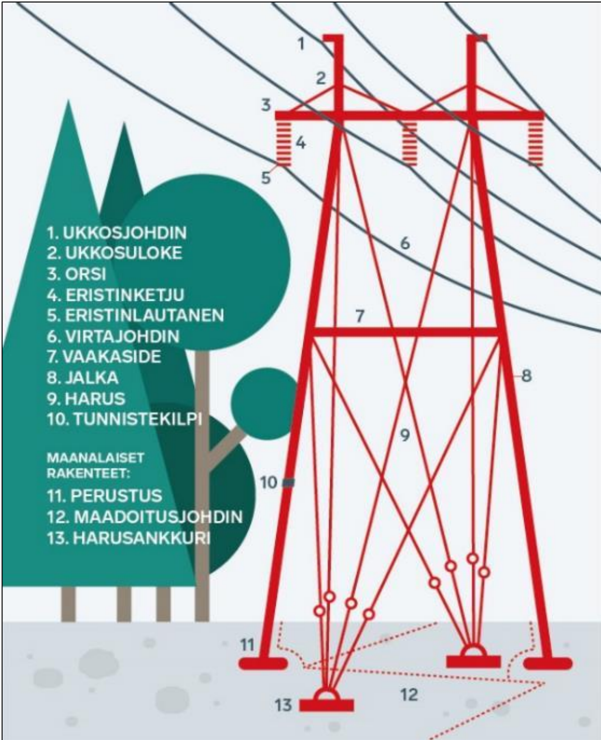
Kuva 3-12. Voimajohdon osat (Lähde: Fingrid 2020).
